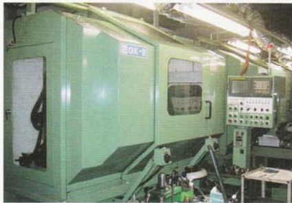
専用砥石成形機による 正確な砥石フォーム
