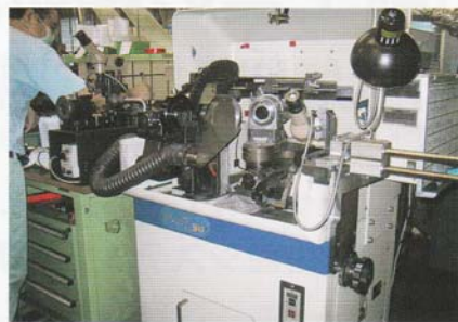
手動機も専用研削盤により 高精度な加工ができる
